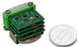
図 1 IoT システムを簡単に創れる Leafony プラットフォーム
