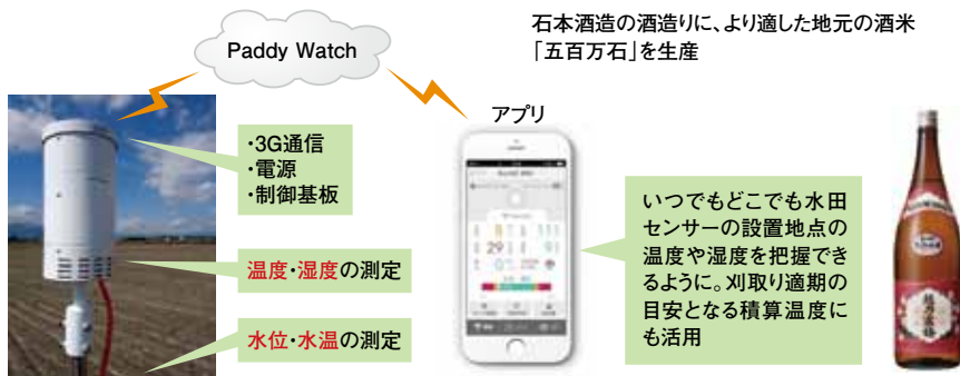
図 良質の米を安定生産する水田管理システム
