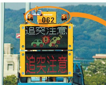
SiLEDシステムの様子(左)と通信BOXの内部(下)。バックミラーで標示を写し、カメラで映像を送る。直接情報板を撮る場合に比べ、カメラを周囲の様子を撮るなどに有効活用できる。
