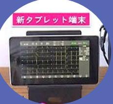
携帯型12誘導心電計とタブレットは、Bluetoothで接続、NFC付き血圧計などからバイタルサインの取り込みが可能
