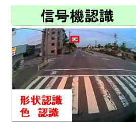
交差点侵入時の 信号の形状と色を認識と記録 <開発中>
